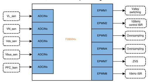
图 2. F28004x Peripheral Usage
