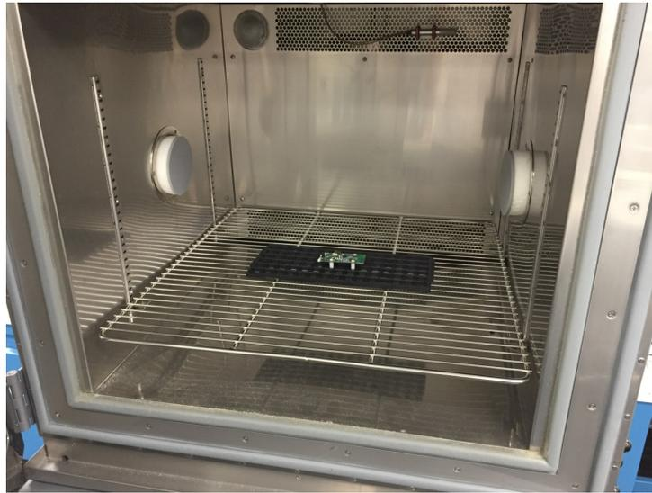
图 19. Temperature Test Setup
