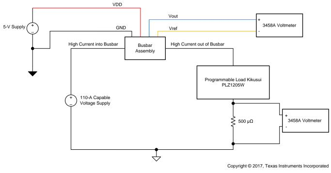
图 6. Test Setup Diagram
