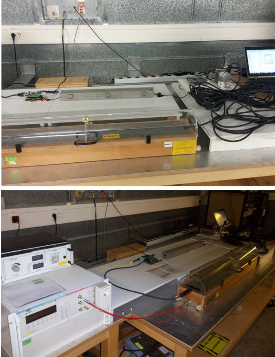
图 7-39. TIDA-00176 的 IEC61000-4-4 EFT 测试设置 (右侧在上, 左侧在下)
