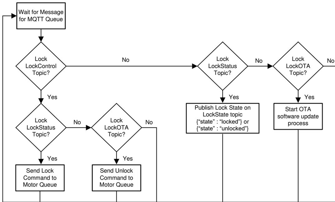
**Figure 2-9. MQTT Message Handling**
