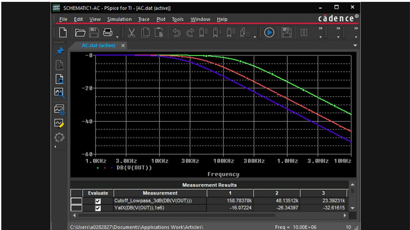
图 2. PSpice for TI 仿真和测量结果
