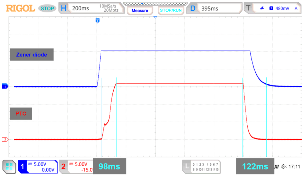
图 4-30. 电流输入模式下 30V 过压时测得的保护响应
