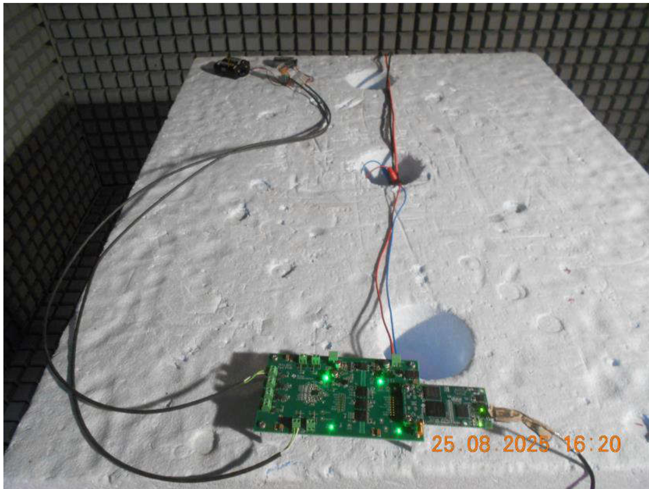
图 3-6. RI 测试的实验室设置
