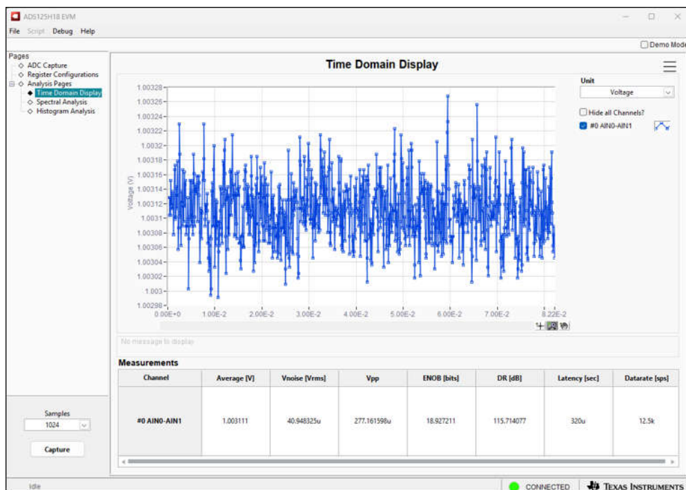
图 1-8. ADS125H18 EMC 测试板 GUI 上的电流测量结果
