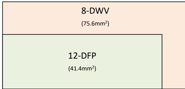
图 3-1.2 通道数字 ISO 面积比较 (mm 2 ) : 传统 8-DWV (宽体 SOIC) 与小型 12-DFP (宽体 SSOP)
