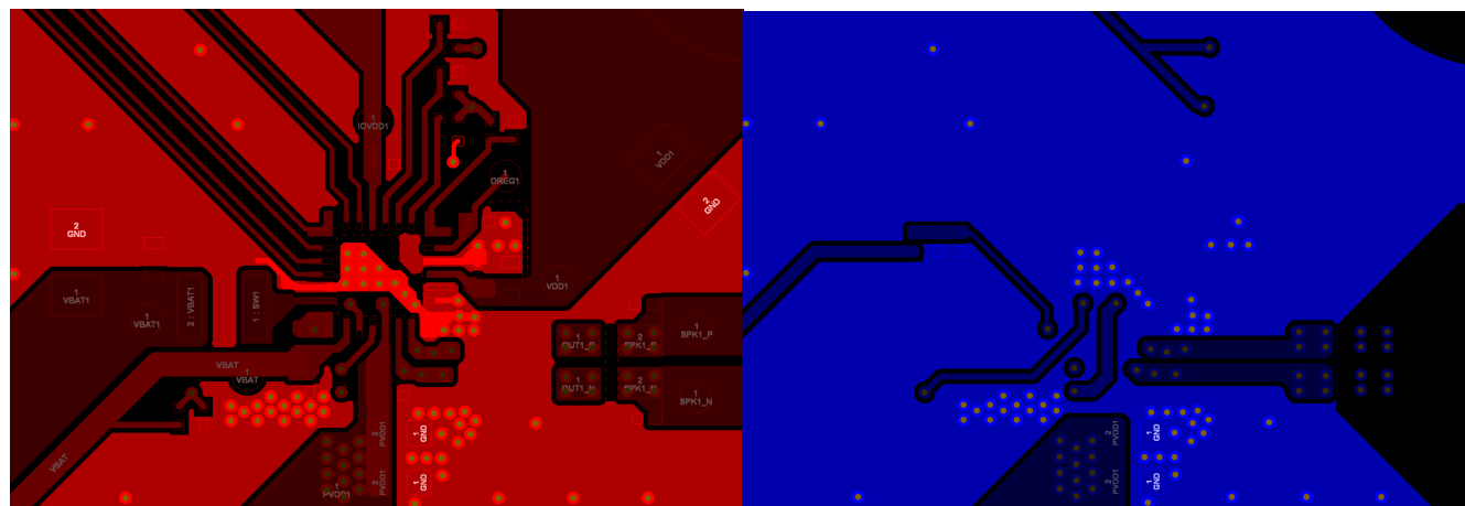
图 3-3. 顶层 (红色) 和底层 (蓝色) — GND 连接硬件控制
