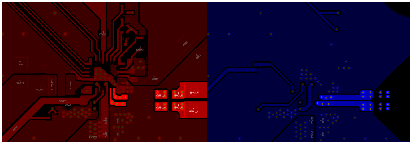
图 3-5. 顶层 (红色) 和底层 (蓝色) — 输出连接硬件控制
