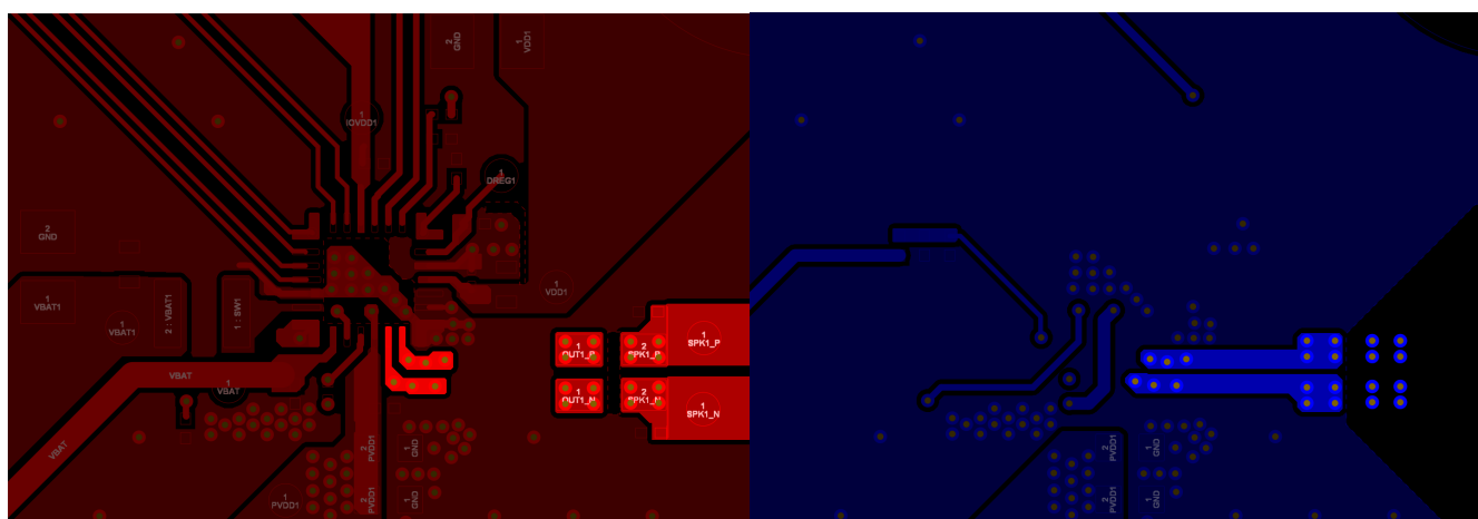
图 3-12. 顶层 (红色) 和底层 (蓝色) — 输出连接软件控制
