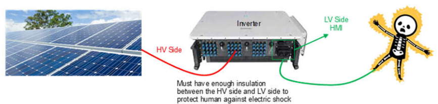
图 3-1. 太阳能逆变器的应用示例
