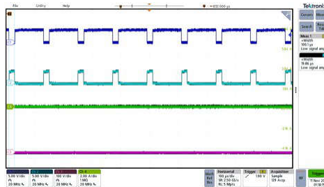
图 4-4. Lab1 波形，Ch1 为 HS PWM，Ch2 为 LS PWM
