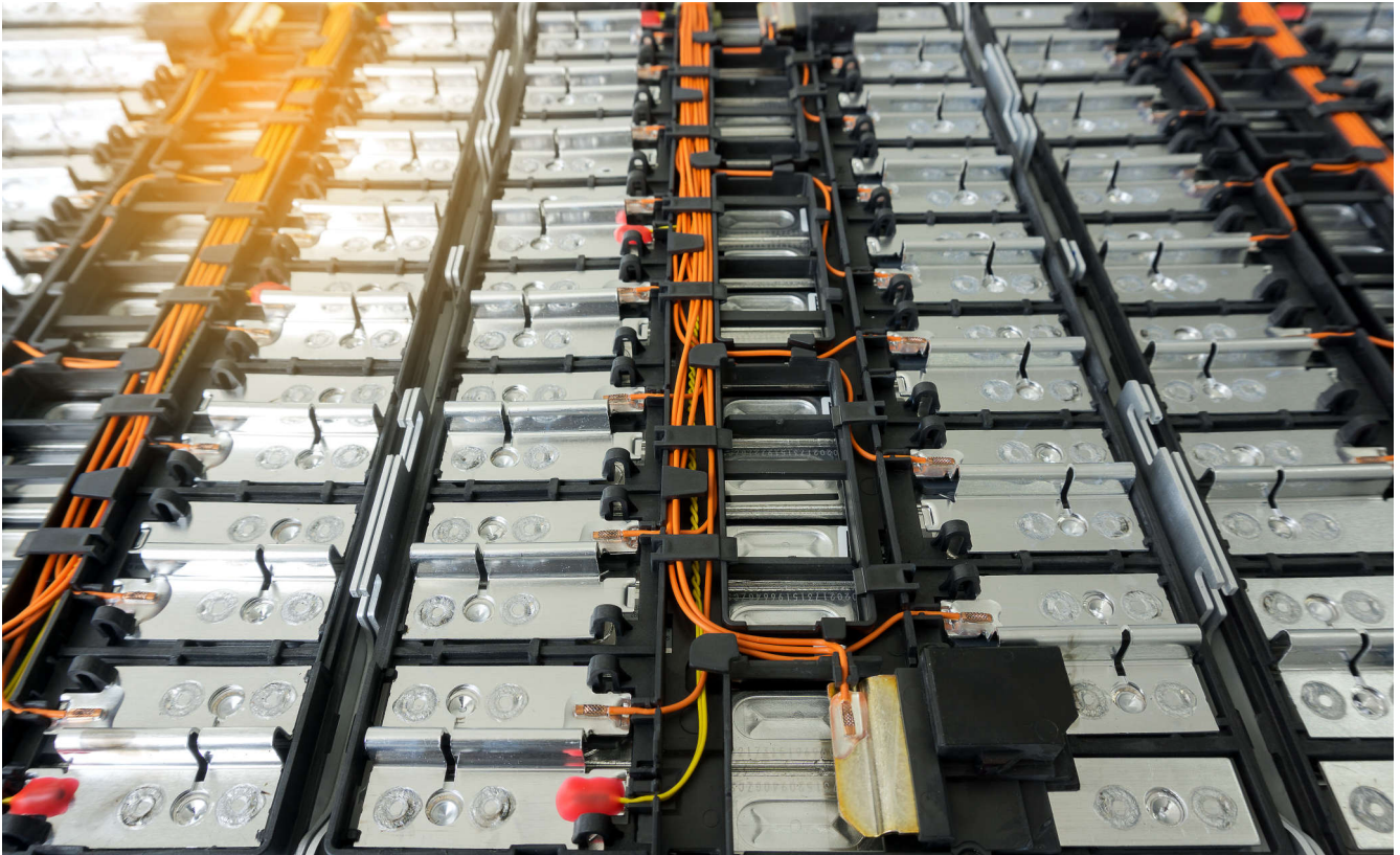
图 3-1. EV 电池包中的锂电芯
