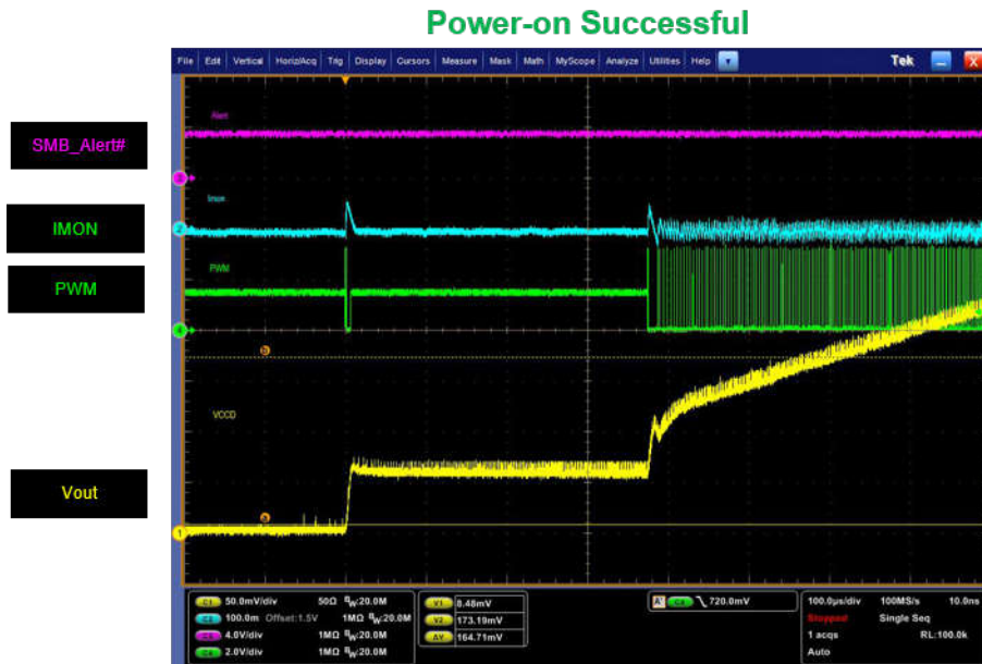
图 6-2. 启用突波抑制且最终 INT_LOW_TC = 1000ns
