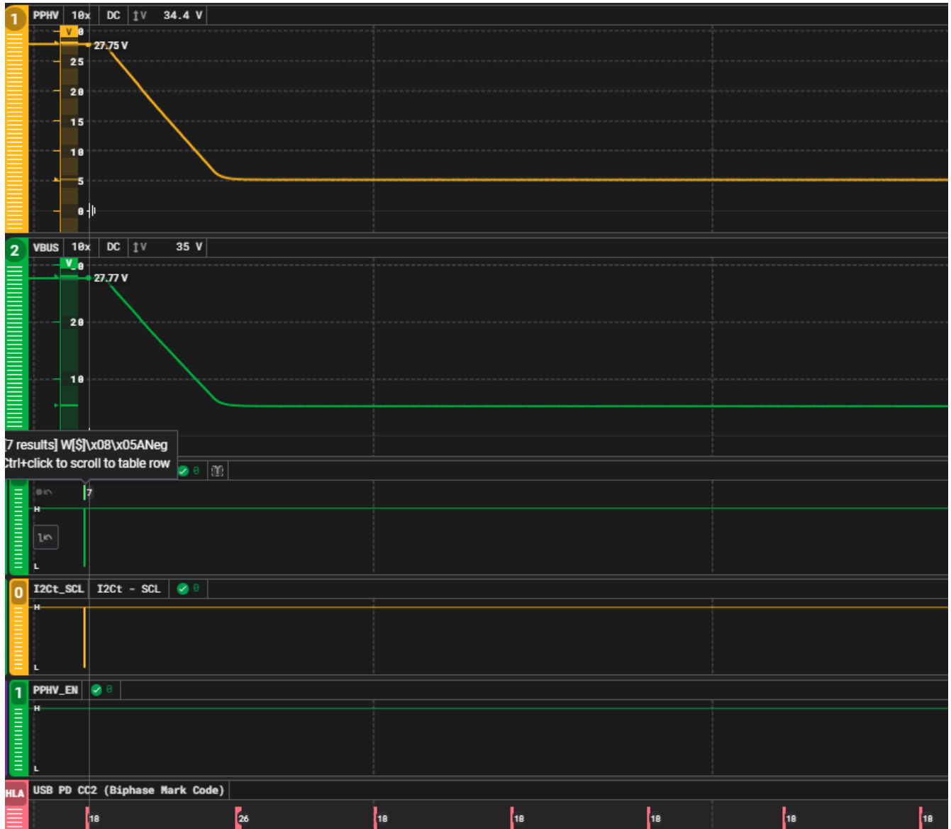
图 6-4. 发送 4CC 'ANeg' 命令将 USB-PD 降至 5V
