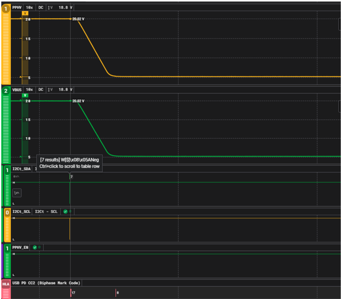
图 6-3. 发送 4CC 'ANeg' 命令将 USB-PD 降至 5V
