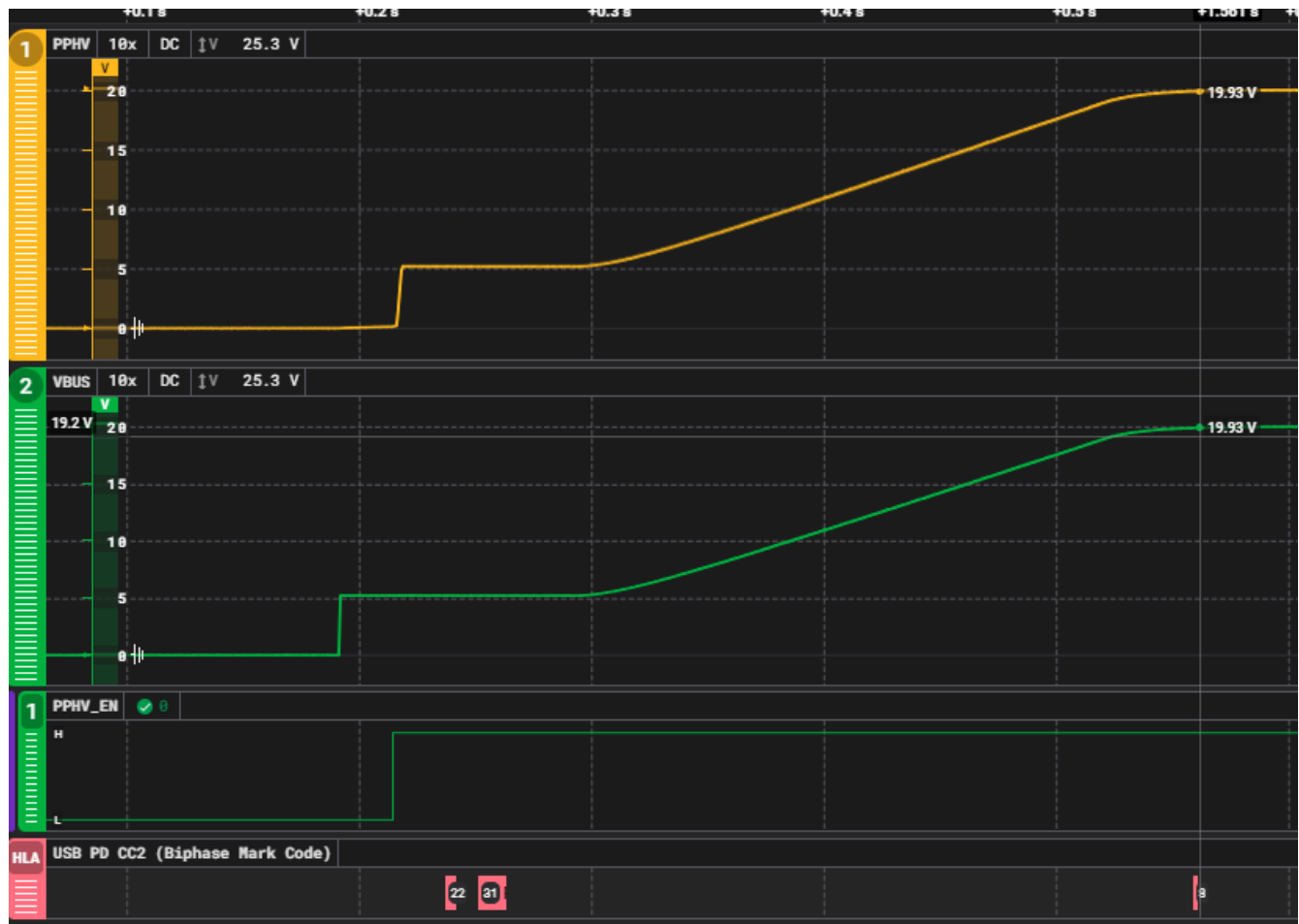
图 6-1. 插入 TPS25751 的 20V USB-PD 供电方
