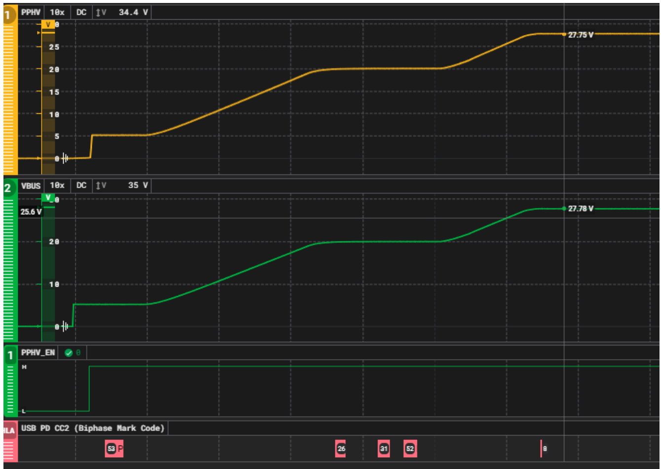
图 6-2. 插入 TPS26750 的 28V USB-PD EPR 供电方
