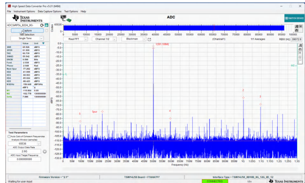
图 6-8. ADC32RF55 性能 FFT 使用经过滤波的 LMX2594 在 2600MSPS 条件下采样， f_{in} = 500\text{MHz}
