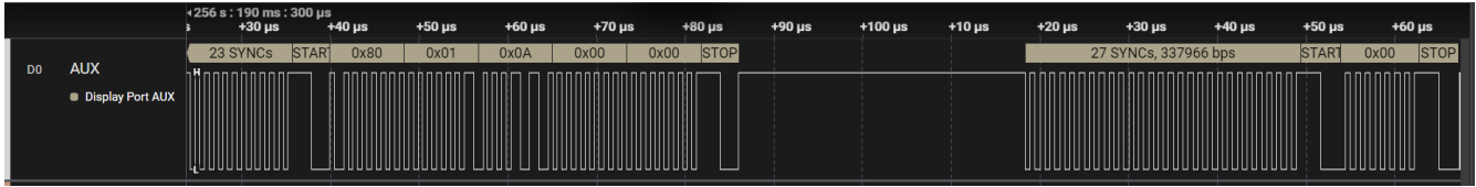
图 4-5. 采用 AUX 分析仪扩展模块的逻辑 2 AUX 波形
