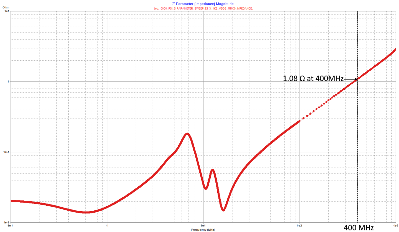
图 3-1. VDDS_MMC0 交流阻抗幅度与频率间的关系 ( 仅限电路板 )
