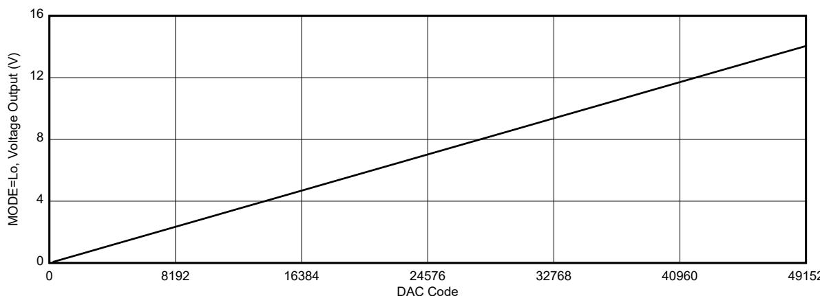
通过输出范围的测量值计算并且绘制非线性度。端点时基故障根据 DAC 代码 256d 至 48934d 计算得出。
