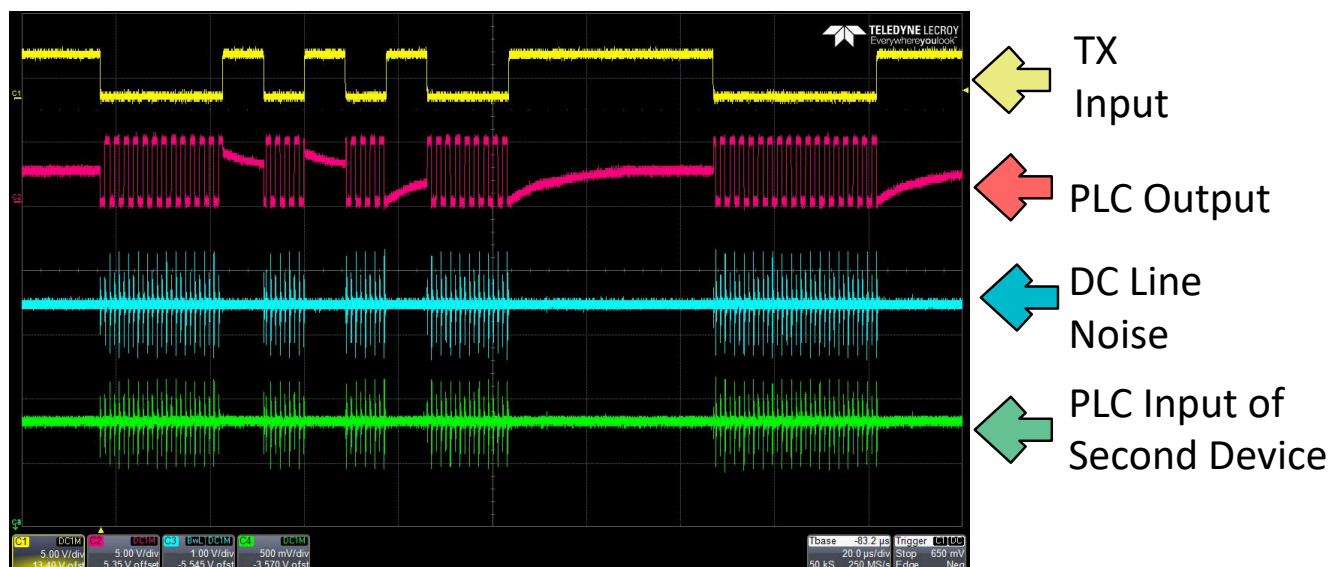
图 6. PLC TX 侧示波器图片
