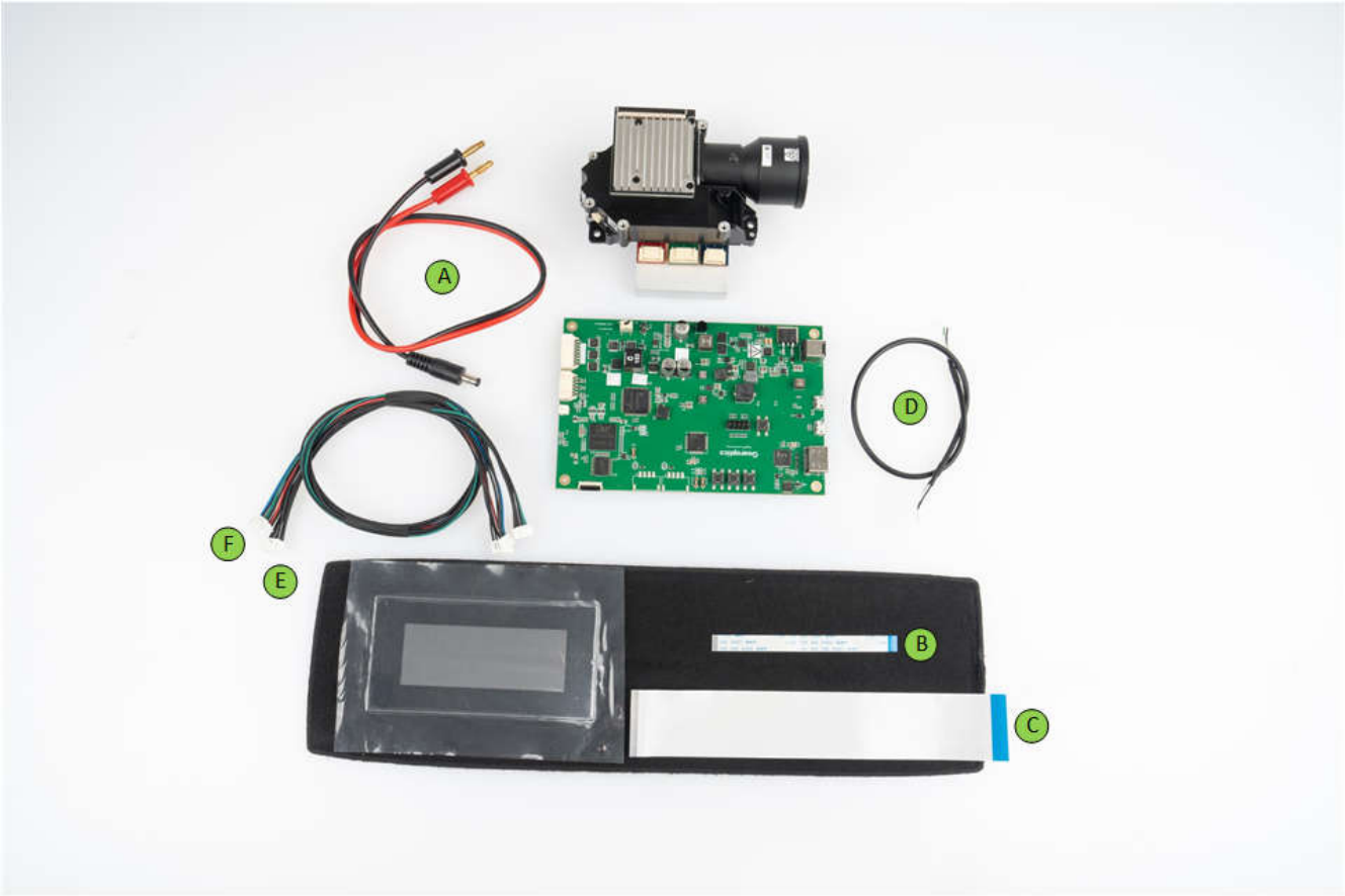
图 1-3. DLP4620SPGUQ1EVM 套件列表 — 电缆标识符
