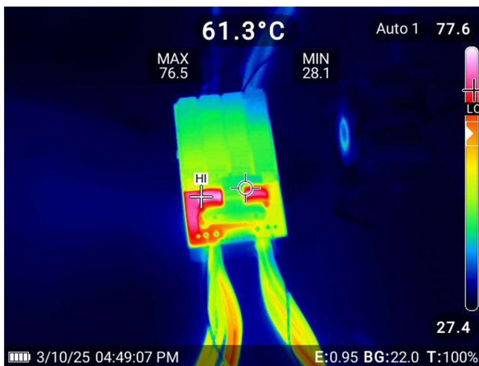
图 3-7. 热成像图 ( 48V - 12V , 1.1kW , 环境温度 25°C , 风量 29.5 立方英尺每分钟 )
