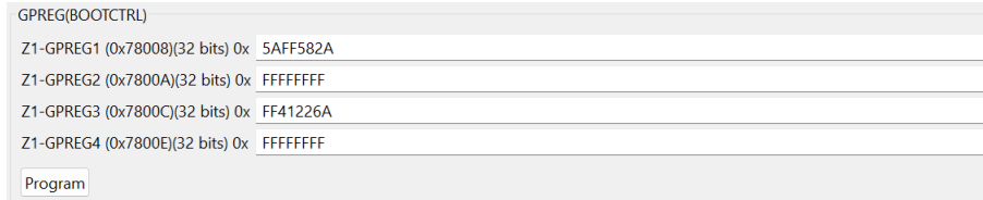
图 5-13. 示例 2 : 已编程的闪存插件引导配置
