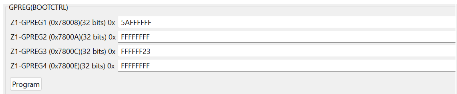
图 5-12. 示例 1：已编程的闪存插件引导配置
