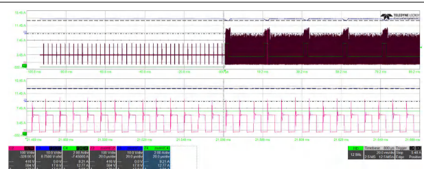
图 3-52. VIN = 90Vac ( 2 倍额定电流并持续 2ms , 0.9 倍额定电流并持续 18ms ) - 缩放版本
