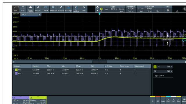
图 3-47. 230Vac 输入电压时的 2KV 浪涌
