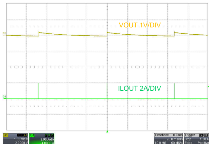
图 3-6. PFM 模式、 V_{SUPPLY} = 48V 、 I_{LOAD} = 0A 条件下的空载运行
