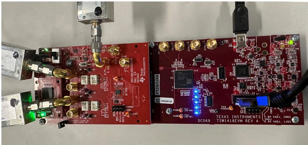
图 2-3. ADC3910D125EVM 的最终设置
