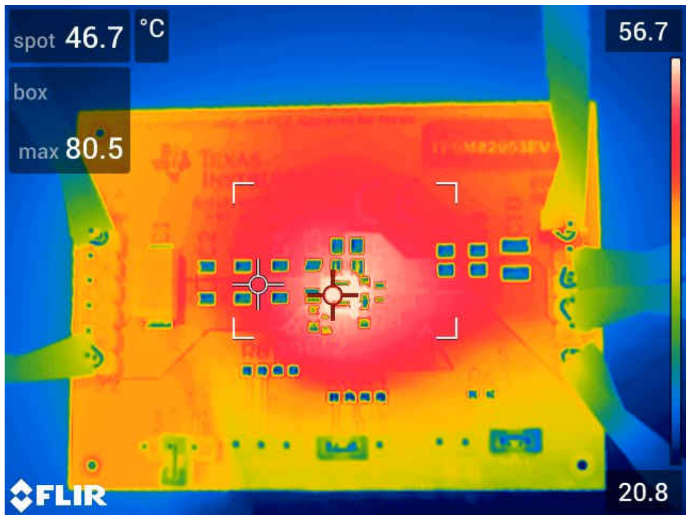
图 4-1. 热性能 ( V_{IN} = 12V , V_{OUT} = 1.2V , I_{OUT} = 3000mA , JP3 打开)
