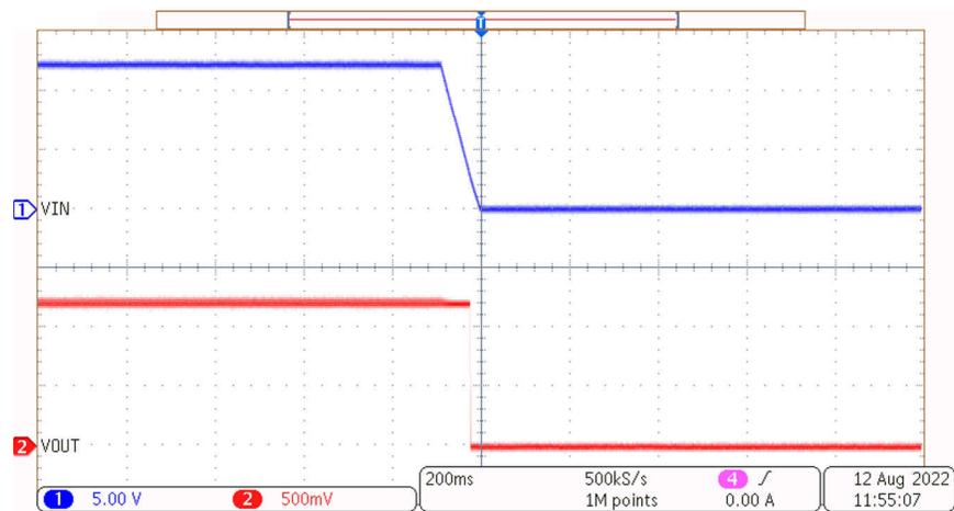
图 3-3. 关断波形
