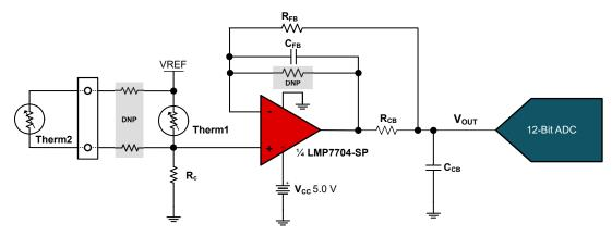
图 2-7. Thermistor Temperature Sensing
