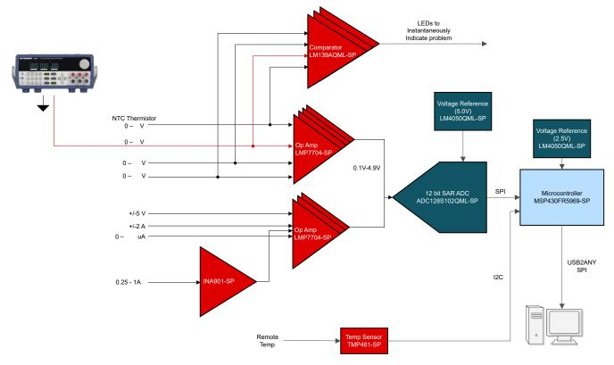
图 3-2. Voltage Monitor Test Setup
