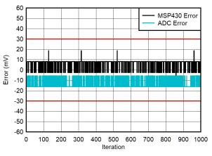
图 3-7. Noise Floor (40-V Range, 0-V Input)
