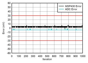
图 3-5. Noise Floor (±5-V Range, 0-V Input)
