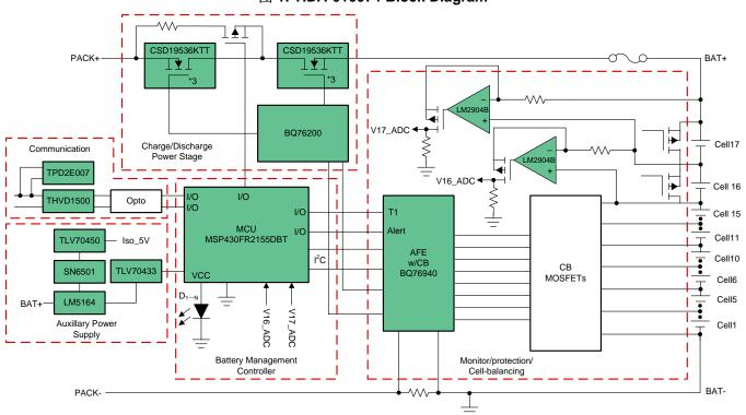
图 1. TIDA-010074 Block Diagram
