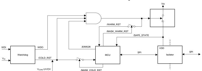
图 6. TIDA-010049 Safe State Logic
