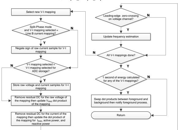
图 14. per sample dsp Function
