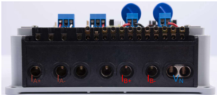
图 3-4. 适用于双电压配置且带有测试设置连接的参考设计前视图
