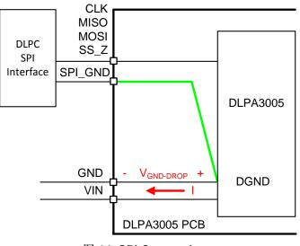
图 14. SPI Connections
