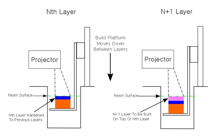
图 3. Top-Down 3D Printing Method
