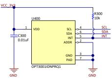
图 15. OPT3001-Q1 Ambient Light Sensor
