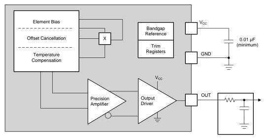
图 8. DRV5055-Q1 Block Diagram
