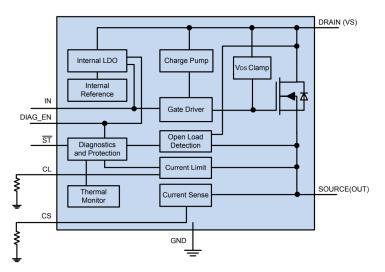
图 2. TPS1H100-Q1 Block Diagram
