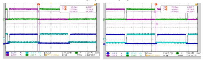
图 20. Dead Time at Falling Edge and Rising Edge of Low-Side PWM
