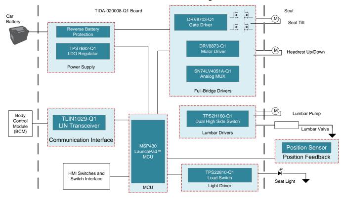
图 1. TIDA-020008 Block Diagram
