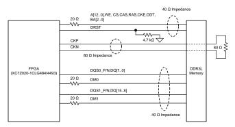
图 10. FPGA-DDR3L Interface
