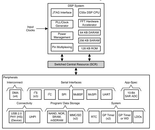
图 7. TMS320C5517 Block diagram
