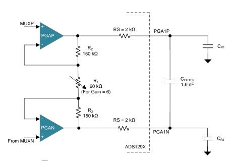
图 10. PGA Implementation in ADS129X Device
