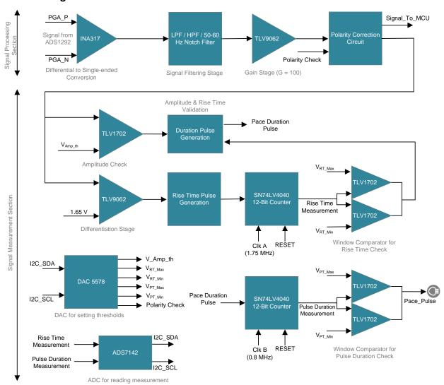
图 4. TIDA-010005 System-Level Block Diagram
