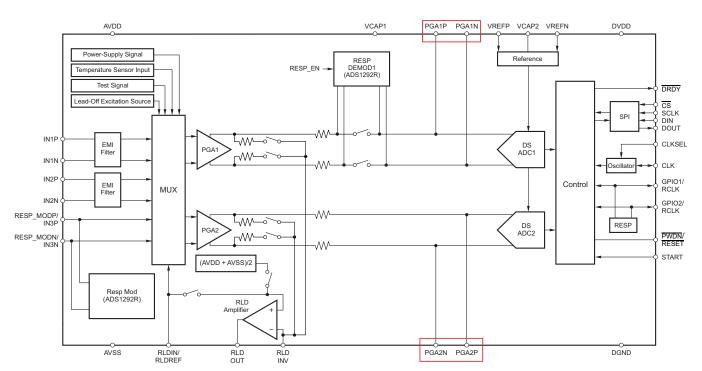
图 9. ADS129X Functional Block Diagram
