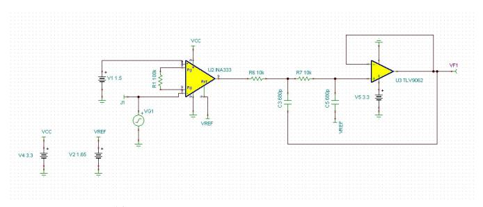
图 13. TINA-TI™ Simulation Circuit of the Low-Pass Filter
