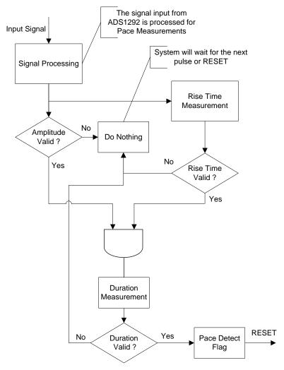
图 7. TIDA-010005 System Flow Diagram
