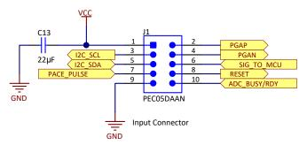
图 8. Input Connector to TIDA-010005
