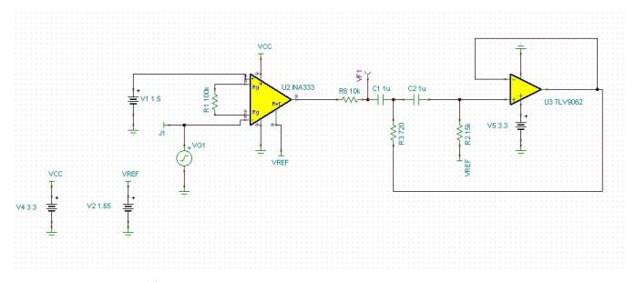
图 18. TINA-TI™ Simulation Circuit of the 50-Hz Notch Filter
