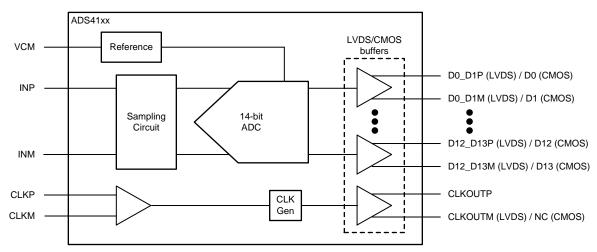
图 1. ADS41xx Block Diagram
