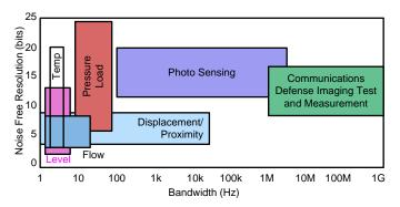
图 7. Noise-Free Resolution Versus Bandwidth
