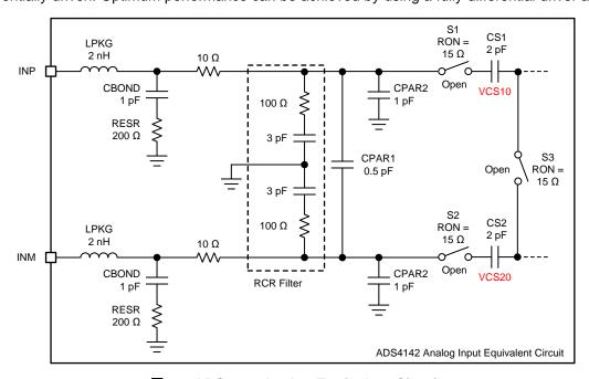
图 11. ADS4142 Analog Equivalent Circuit
