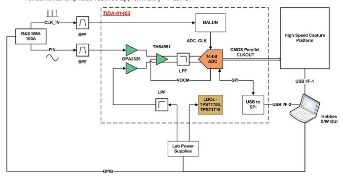
图 25. TIDA-01403 Test Setup
