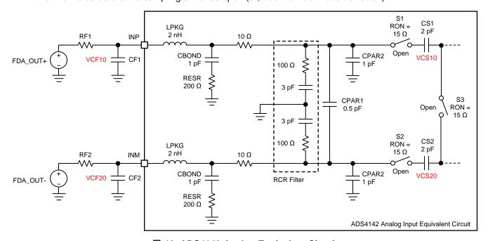
图 13. ADS4142 Analog Equivalent Circuit
