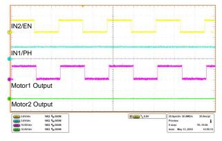
图 18. Forward Gate Drive Signals
