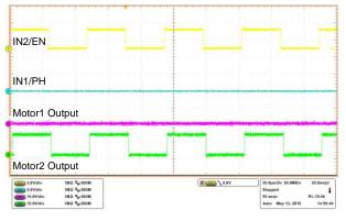
图 19. Reverse Gate drive Signals
