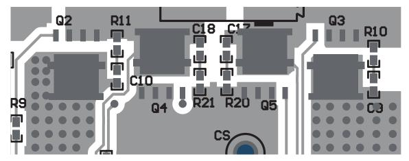
图 38. MOSFET Drain Layout
