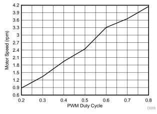
图 29. Motor Speed With PWM Duty Cycle
