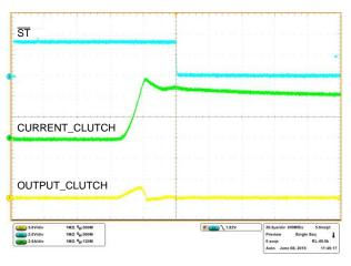
图 28. TPS1H100-Q1 Overcurrent Protection
