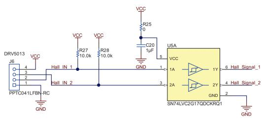
图 7. Hall Effect Sensor Circuit
