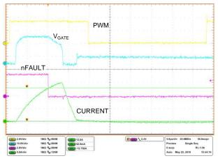
图 27. DRV8703-Q1 Overcurrent Protection
