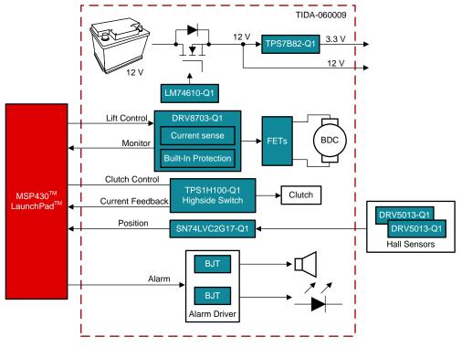
图 2. TIDA-060009 Block Diagram
