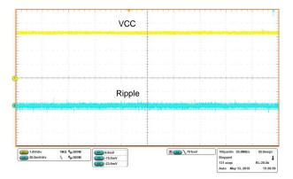
图 15. 3.3-V Voltage and Ripple
