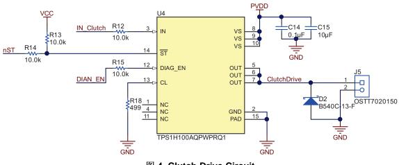
图 4. Clutch Drive Circuit
