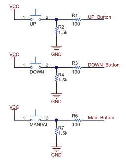
图 9. Push-Button Circuit
