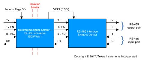
图 1. TIDA-00892 Block Diagram
