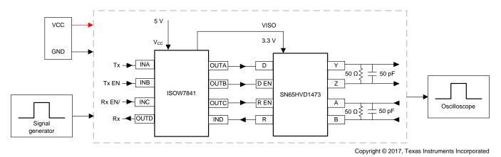
图 5. Typical Test Setup
