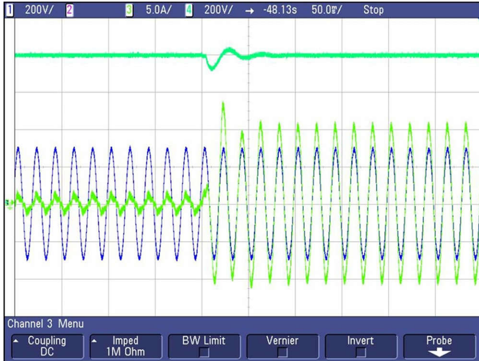
图 3-43. 电压阶跃 - 400W → 4.4kW
