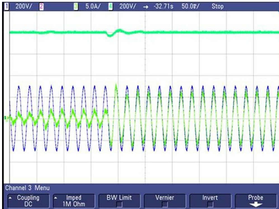
图 3-42. 电压阶跃 - 400W → 2.4kW
