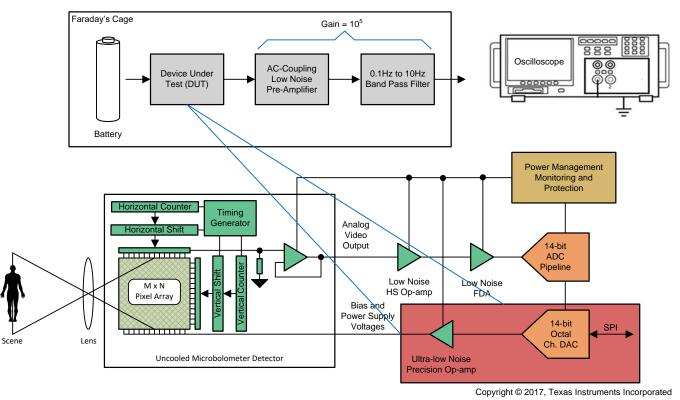
图 41. 1/f Noise Measurement Setup
