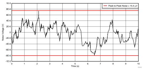
图 43. 0.1-Hz to 10-Hz Noise for Bias Voltage Circuit
