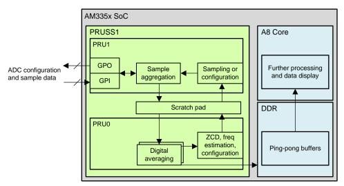
图 12. Software Data Flow Diagram
