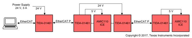
图 9. Communication Test Setup
