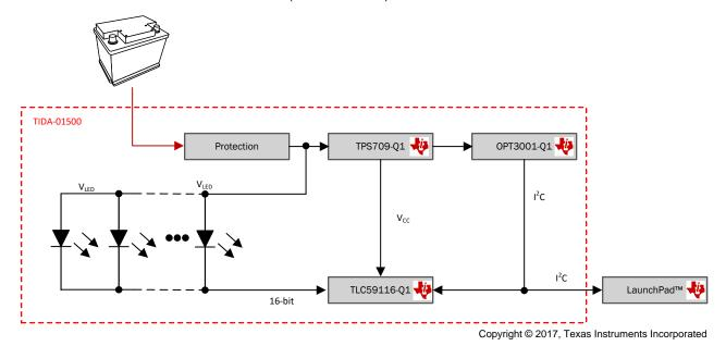
图 1. TIDA-01500 Block Diagram
