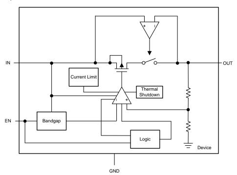
图 2. TPS709-Q1 Block Diagram
