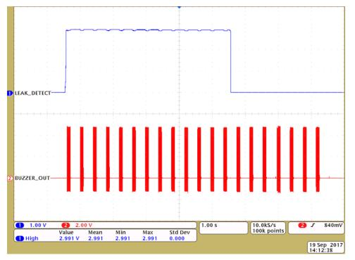
图 26. Leak Detection Response
