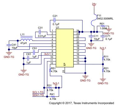
图 14. DRV10983-Q1 Socket Schematic
