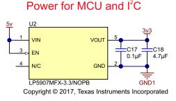
图 5. LP5907 Configuration for 3V3 Rail
