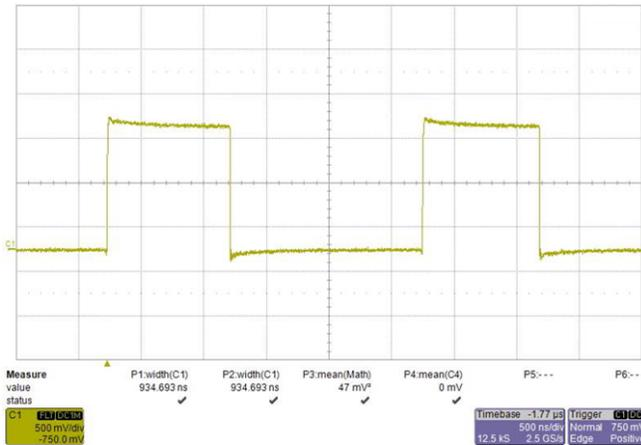
图 30.  $V_{IN} = 14.5\text{ V}$ ,  $f_{SW} = 400\text{ kHz}$
