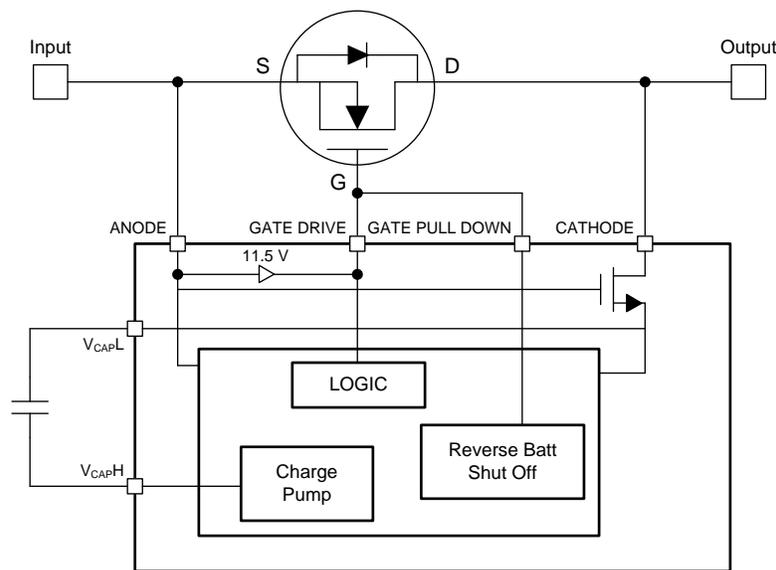
图 8. LM74610-Q1 Functional Block Diagram
