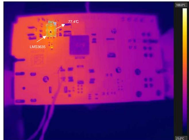
图 44. LMS3635-Q1 IC at 77.4°C:  $V_{IN} = 14.5\text{ V}$ ,
