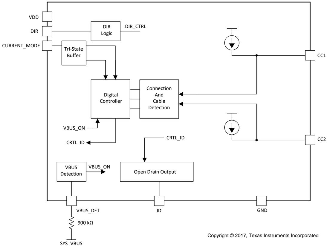
图 4. TUSB319-Q1 Functional Block Diagram
