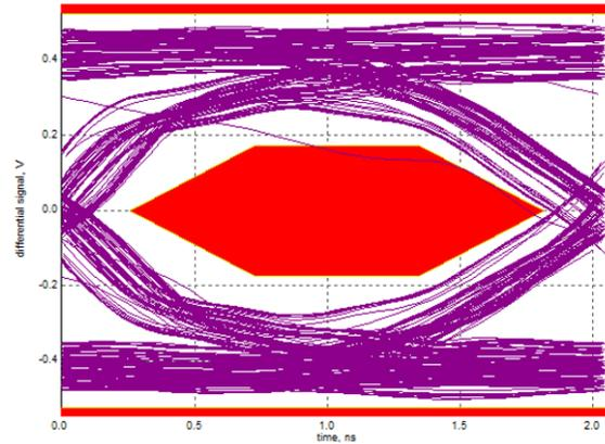
图 54. Far-End USB-IF Test With TUSB213-Q1 Enabled
