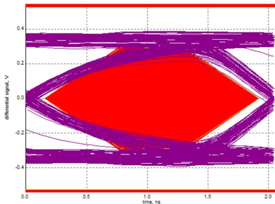
图 49. Near-End USB-IF Test With TUSB213-Q1 Disabled
